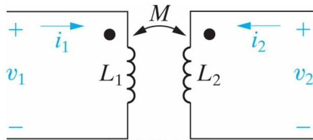
$$p = v_1 i_1 = i_1 L_1 \frac{di_1}{dt} = \frac{dw}{dt}$$
